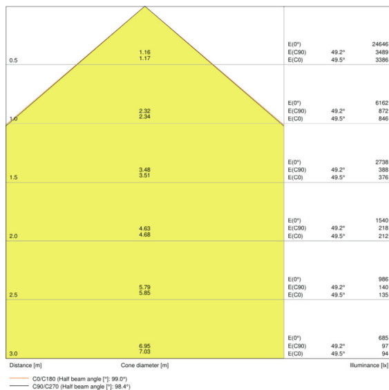
Courbe photométrique, selon un angle donné
